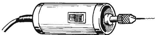
Fig. 9 - Il minitrapano non è un utensile strettamente necessario nel laboratorio dilettaistico, ma in molte occasioni può rivelarsi oltremodo utile, soprattutto nelle operazioni di foratura dei circuiti stampati.
